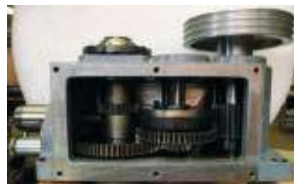
Scatola ingranaggi in bagno d'olio.
